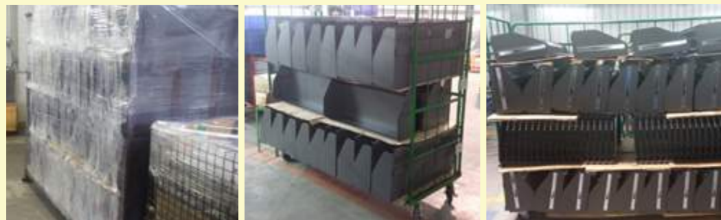
圖 1 改善前用傳統的抽屜籠裝載抽屜 圖 2 第一次改善後抽屜備料車，數量及高度固定；但是堆疊方式不整齊、易倒榻
