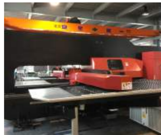
圖 6 NCT 沖孔機安裝完畢
