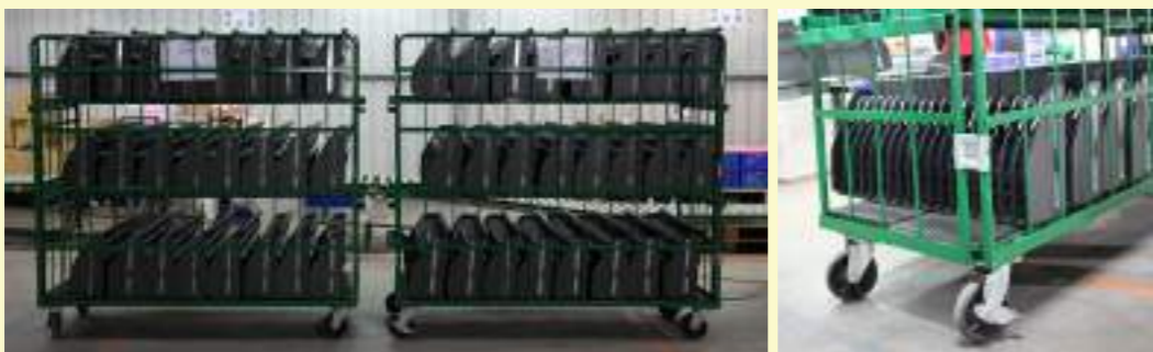
圖 3 新版充電車抽屜備料台車，有安裝輪子容易推動
