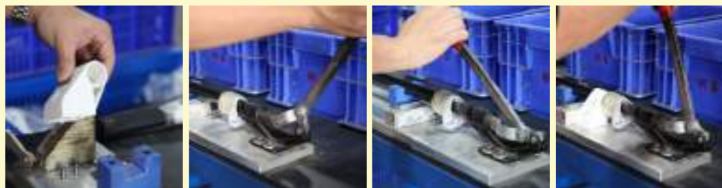
圖 4 左邊物料對準定位點 圖 5 左邊物料對準 + 放上側把手，直接安裝 圖 6 最後放上右邊塑膠物料，直接安裝，就完成側把手的前置安裝作業，節省工時約 40 秒
